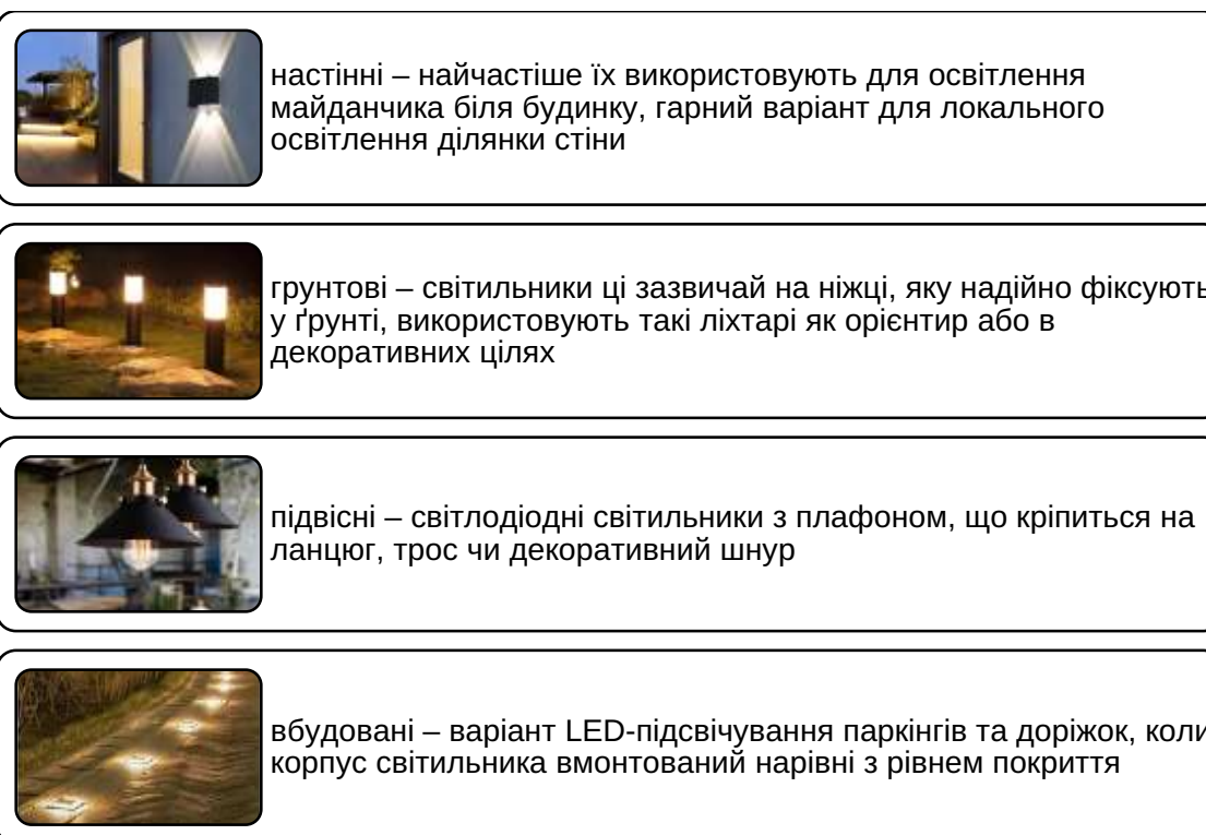
Рис. 2. Класифікація сонячних ліхтарів залежно від способу їх монтажу
