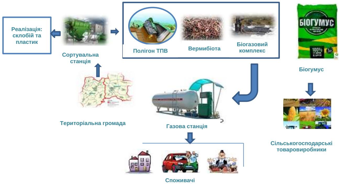
Рис. 1. Модель територіального кластера орієнтованого на виробництво біогазу з відходів підприємств і домогосподарств (на базі полігонів твердих побутових відходів)
